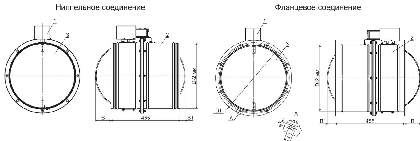
1 - электропривод; 2 - корпус клапана; 3 - заслонка.
