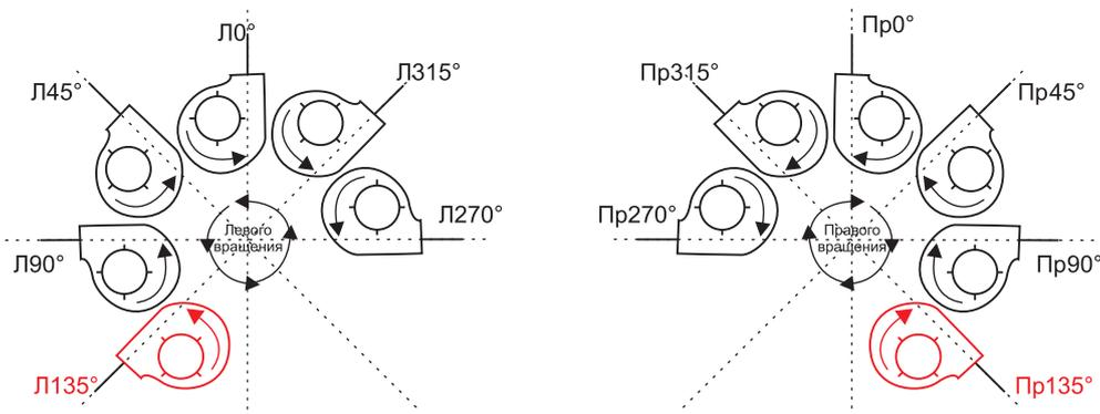
**Вентилятор правого вращения** - вентилятор, рабочее колесо которого вращается по часовой стрелке - вид со стороны всасывания.
