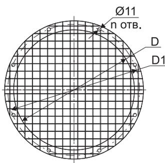
Козырек РОСА предназначен для защиты осевых вентиляторов РОСА-500 и РОСА-SMF от атмосферных осадков.
