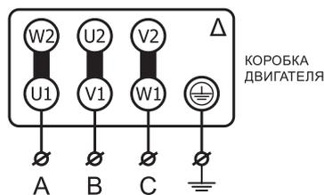
\* В вентиляторах с номинальным напряжением Δ/Y 380В/660В предусмотрена возможность запуска пониженным напряжением по схеме Y-Δ. Для получения более подробной информации по подключению, обратитесь в отдел технической поддержки.
