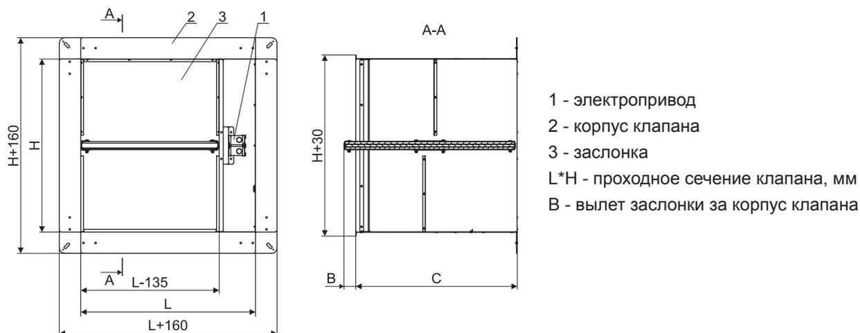
**Габаритные размеры клапана ОЗ-60 прямоугольного сечения стенового типа**
