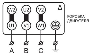
\* В вентиляторах с номинальным напряжением Δ/У 380В/660В предусмотрена возможность запуска пониженным напряжением по схеме У-Δ. Для получения более подробной информации по подключению, обратитесь в отдел технической поддержки.
