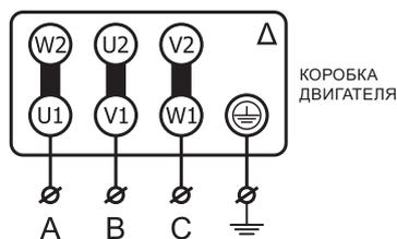
\* В вентиляторах с номинальным напряжением Δ/Υ 380В/660В предусмотрена возможность запуска пониженным напряжением по схеме Υ-Δ. Для получения более подробной информации по подключению, обратитесь в отдел технической поддержки.
