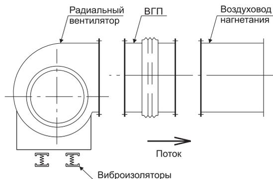
Установка клапана вертикального выброса на стороне нагнетания радиального вентилятора (при угле поворота корпуса вентилятора 0°)
