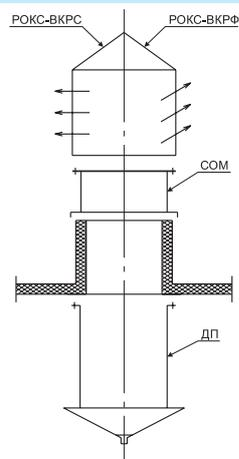
Схема установки вентилятора ВОП-20 на стакан опорный монтажный СОМ с установкой дренажного поддона
