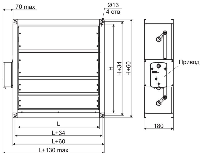
**ЗАТВОР-ДУ с приводом внутри**
