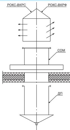
Установка РОКС на плоской кровле с использованием стакана СОМ на железобетонном основании, с установкой дренажного поддона под вентилятором
