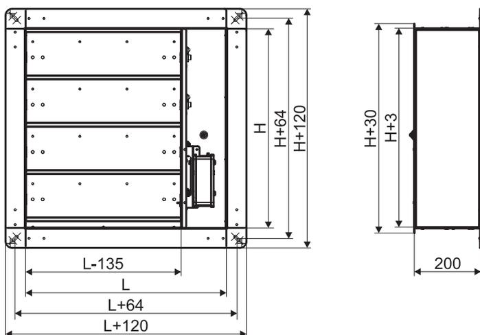
Минимальный размер клапана (L\*H) - 300\*300 мм, далее с шагом 50 мм в соответствии с таблицей типоразмерного ряда и значения площади живого сечения клапанов ДМУ МС.
