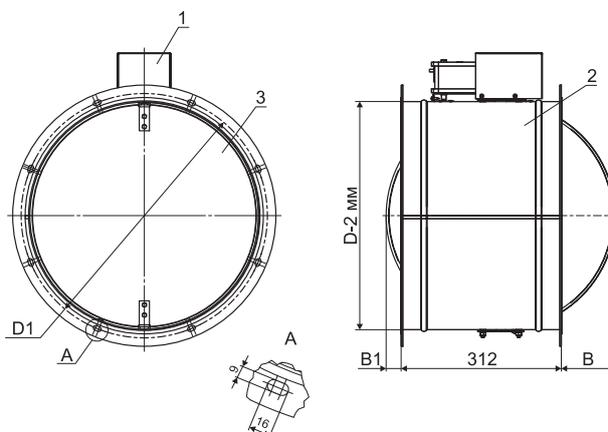
1 - электропривод; 2 - корпус клапана; 3 - заслонка.
