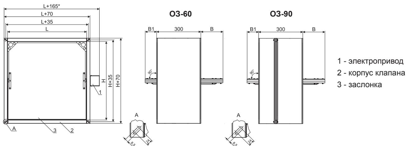
L\*H - проходное сечение клапана, мм; В, В1 - вылет заслонки за корпус клапана
