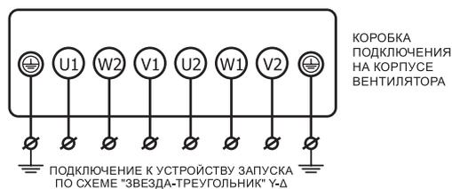
ПОДКЛЮЧЕНИЕ К УСТРОЙСТВУ ЗАПУСКА ПО СХЕМЕ "ЗВЕЗДА-ТРЕУГОЛЬНИК" Y-Δ
