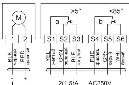
**Электрический реверсивный привод РОВЕН**
