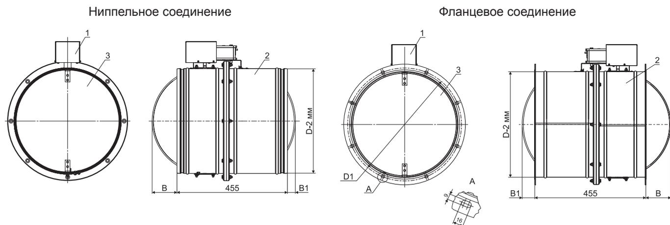
1 - привод; 2 - корпус клапана; 3 - заслонка.
