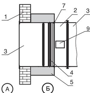
**Стеновой тип клапана**
