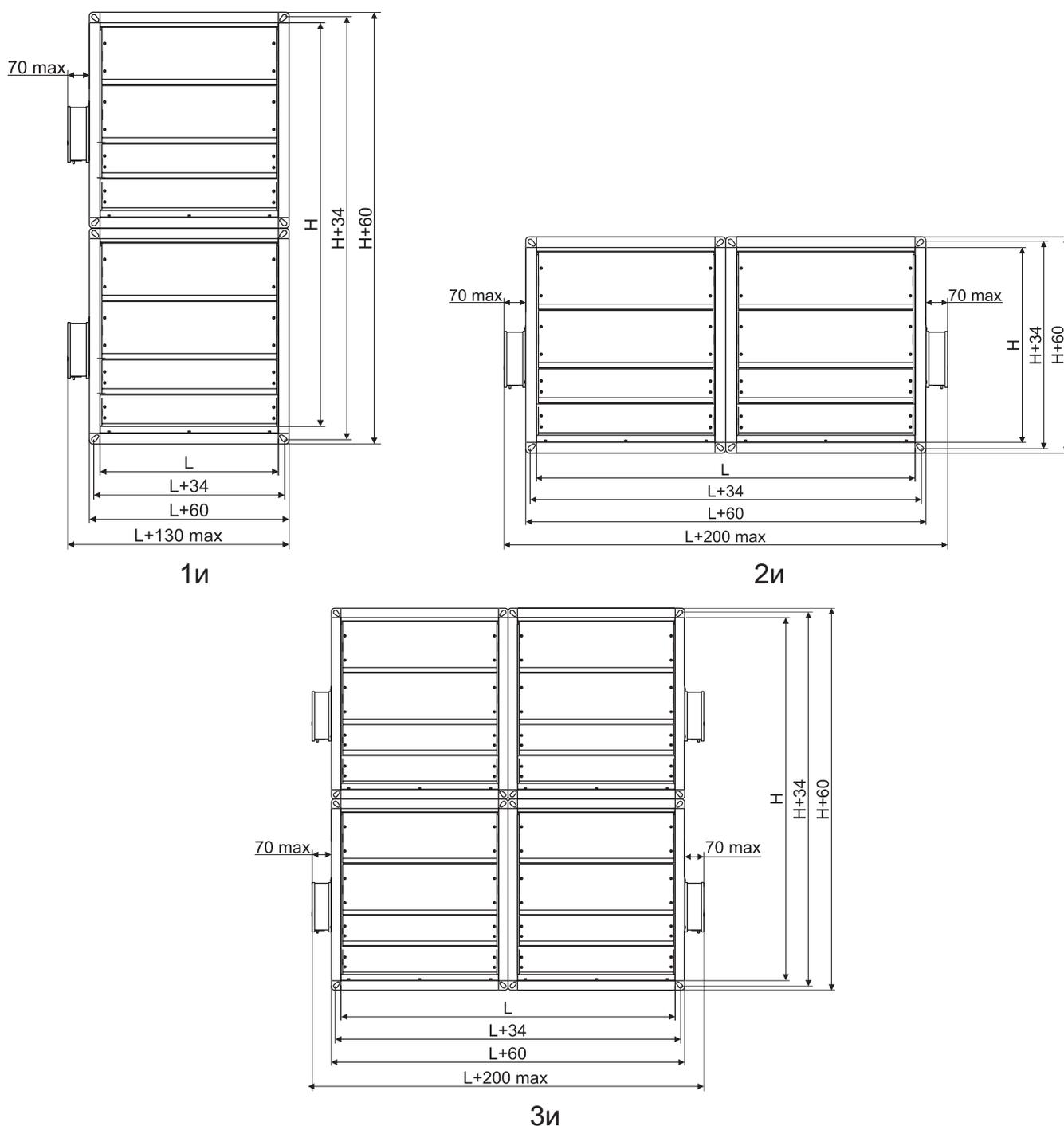
Клапаны стенового типа в виде кассет
