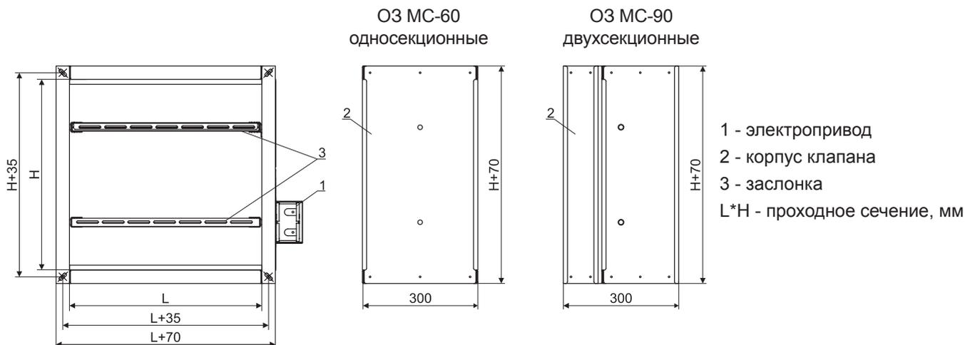
**Клапаны ОЗ МС-60 и ОЗ МС-90 стенового типа**
