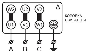
\* В вентиляторах с номинальным напряжением Δ/Y 380В/660В предусмотрена возможность запуска пониженным напряжением по схеме Y-Δ. Для получения более подробной информации по подключению, обратитесь в отдел технической поддержки.
