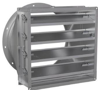
Клапаны лепестковые предназначены для установки на нагнетательной стороне осевых вентиляторов РОСА-500 с целью предотвращения попадания холодного воздуха и атмосферных осадков в производственные помещения после отключения вентиляторов. Изготавливаются из оцинкованной стали.
